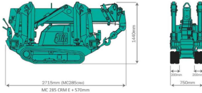
**Abmessungen bei voll ausgefahrener Abstützung**
